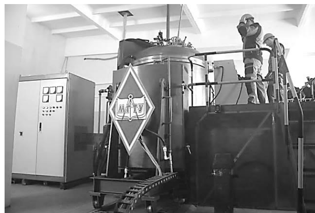
Рис. 5. Выплавка стали в лабораторной вакуумной индукционной печи ZG–0.06L
